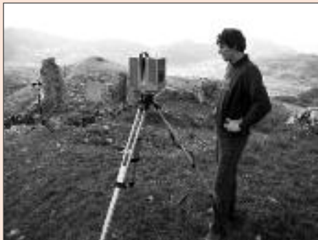
Rilievo delle case a torre con laser scanner messo a disposizione da 3D Target di Brescia
