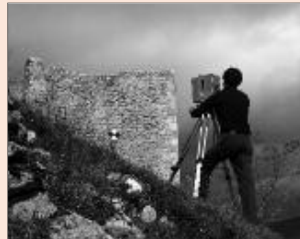
Rilievo delle case a torre con laser scanner messo a disposizione da 3D Target di Brescia
