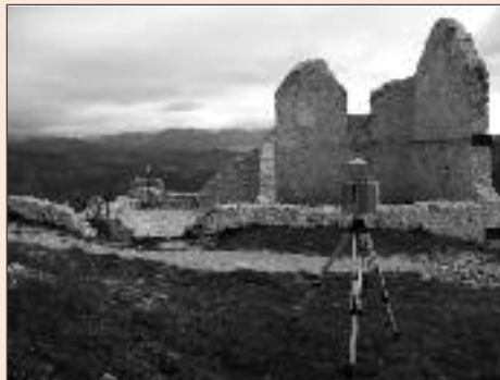
Rilievo delle case a torre con laser scanner messo a disposizione da 3D Target di Brescia
